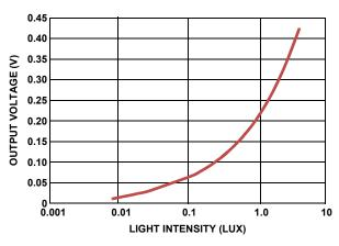
FIGURE 9. OUTPUT VOLTAGE vs LIGHT INTENSITY 0.01 LUX TO
