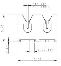
Code Wire Gauge Α 0.20 28AWG 001 002 26AWG 0.28
